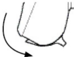
С помощью ногтевого зацепа плавно откройте батарейный отсек.
