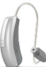
WIDEX UNIQUE MINI-RIC основан на новой платформе U от WIDEX с технологией классификации звуков, которая автоматически классифицирует звуковую окружение и оптимально обрабатывает звук в зависимости от звукового класса.
