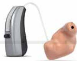
WIDEX DREAM RIC основан на уникальной беспроводной технологии WidexLink и новой платформе TRUE ISP с технологией True-Input. Переключение программ на корпусе и через RC-DEX/M-DEX. Регулировка громкости через RC-DEX/M-DEX. Следует использовать батарейку 312.
