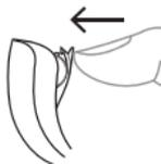
Чтобы включить слуховой аппарат, закройте крышку батарейного отсека. При включении слухового аппарата вы услышите звуковой сигнал, если ваш специалист не отключил эту функцию.
