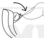
Чтобы выключить слуховой аппарат, надавите на крышку батарейного отсека вниз.
