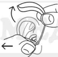
Сначала снимите слуховой аппарат с уха. Аккуратно вытащите модуль ушного вкладыша из слухового прохода, придерживая нижнюю часть трубочки.
