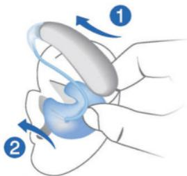
После использования очистите и высушите слуховой аппарат. Подробные сведения см. в разделе "Техническое обслуживание и уход".
