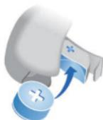
Благодаря магниту в батарейном отсеке батарея со слышимым звуком фиксируется на своем месте.
