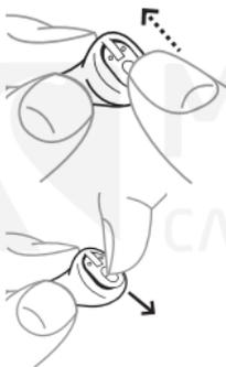
Чтобы включить слуховой аппарат, закройте крышку батарейного отсека и сдвиньте ее вверх. Слуховой аппарат воспроизведет звуковой сигнал, сообщающий о включении, если только ваш аудиолог не отключил эту функцию.
