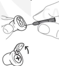
Очищайте вентиляционный канал ежедневно, пропуская длинный инструмент для удаления серы (№ 3) через вентиляционный канал насквозь.
