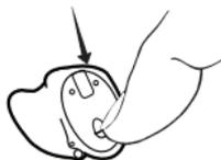
Используйте ногтевой зацеп, чтобы сдвинуть крышку отсека батареи вниз и открыть крышку.
