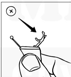
Поместите батарейку в отсек так, чтобы маленький знак «+» на батарейке был виден одновременно со знаком «+», отпечатанным на круглой крышке батарейного отсека. Если батарейка вставлена правильно, батарейный отсек закрывается без усилий.
