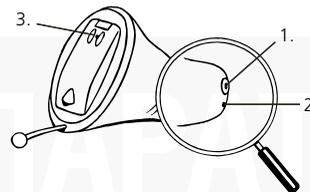
Ниже приведен еще один пример расположения отверстия выхода звука, вентиляционного отверстия и входа микрофона. На этом рисунке показан слуховой аппарат с **длинным вентиляционным отверстием**. На Вашем слуховом аппарате они могут располагаться немного иначе.
