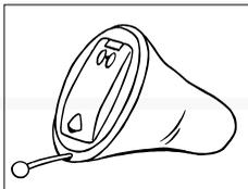
Батарейный отсек Вашего слухового аппарата AIKIA совмещает функции переключателя Вкл./Выкл. (on/off). Слуховой аппарат автоматически **включается**, когда батарейка вставлена правильно и батарейный отсек плотно закрыт.
