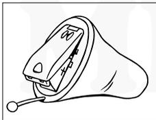
Слуховой аппарат **выключен** при открытом батарейном отсеке.
