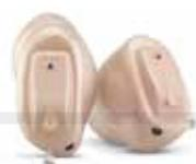
WIDEX UNIQUE CIC MICRO основан на новой платформе U от WIDEX с технологией классификации звуков, которая автоматически классифицирует звуковое окружение и оптимально обрабатывает звук в зависимости от звукового класса.
