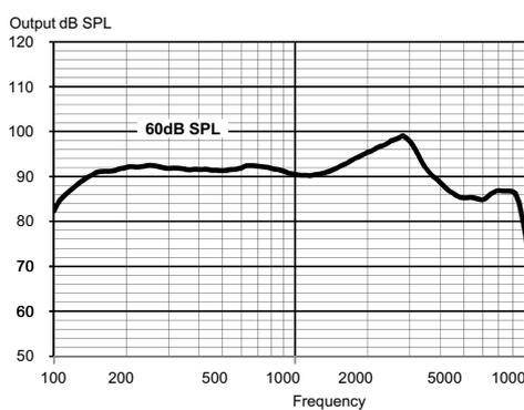
**Технические характеристики** Типичные данные, полученные после стандартных измерений с помощью чистого тона. Слуховой аппарат установлен в Compass в тестовом режиме 1 (если нет других указаний). Измерения выполняются с помощью стандартной камеры для ITE.
