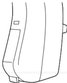
Для включения слухового аппарата закройте батарейный отсек. При включении слухового аппарата Вы услышите сигнал, если данная функция включена.
