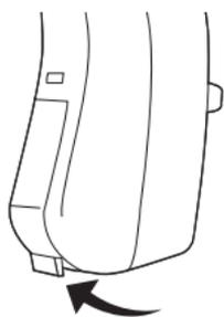
С помощью зацепа для ногтя аккуратно откройте крышку батарейного отсека. Не выводите батарейный отсек в за-предельное положение.
