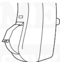
Когда Вы не используете слуховой аппарат, следует оставлять батарейный отсек открытым, чтобы слуховой аппарат проветривался.
