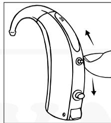
Ваш слуховой аппарат может быть оснащен электронным регулятором громкости в виде рычажка. Нажмите рычажок вверх, чтобы увеличить автоматически настроенную громкость. Нажмите рычажок вниз, чтобы уменьшить громкость. Для того чтобы немного изменить уровень громкости, используйте короткие нажатия. Для быстрого изменения уровня громкости необходимо удерживать регулятор нажатым в течение нескольких секунд.
