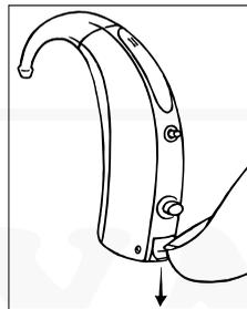
Батарейный отсек расположен в нижней части слухового аппарата. Батарейный отсек совмещает функции переключателя вкл./выкл.
