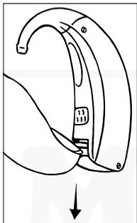
Откройте батарейный отсек слухового аппарата, нажав вниз ногтем на зацеп батарейного отсека. Зацеп расположен в нижней части слухового аппарата - на противоположной стороне от переключателя вкл./выкл.
