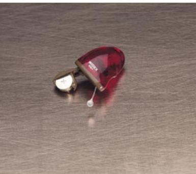
В крошечных глубоководных аппаратах батарейка расположена внутри крышки батарейного отсека.
